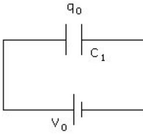
1. Dopo che il condensatore  $C_1$  si è caricato ed è poi connesso al condensatore  $C_2$ , una certa carica scorre da  $C_1$  a  $C_2$  fino a che non si raggiunge una condizione di equilibrio in cui entrambi i condensatori presentano la stessa differenza di potenziale  $V$ .
