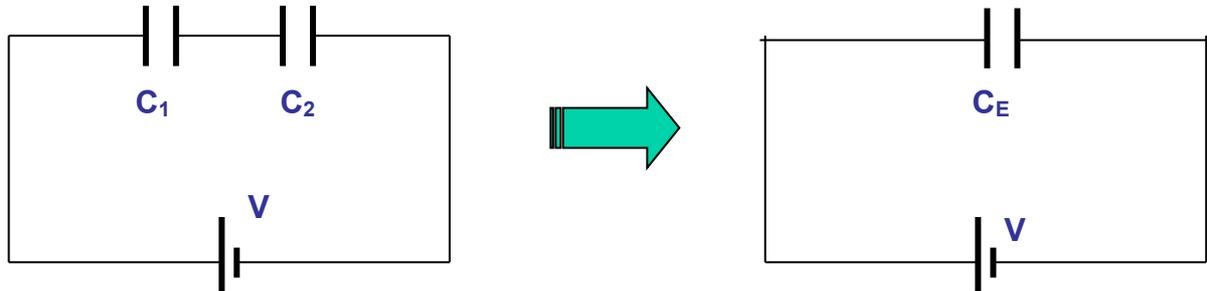
Poiché i condensatori sono in serie, sulle loro armature si accumulerà una stessa carica, che è la stessa che si accumula sul condensatore equivalente:
