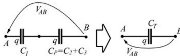
poi dobbiamo constatare che  $q = C_T V = 2 \cdot 10^{-6} \cdot 300 = 600 \mu\text{C}$  ovviamente;  $q = q_1$
