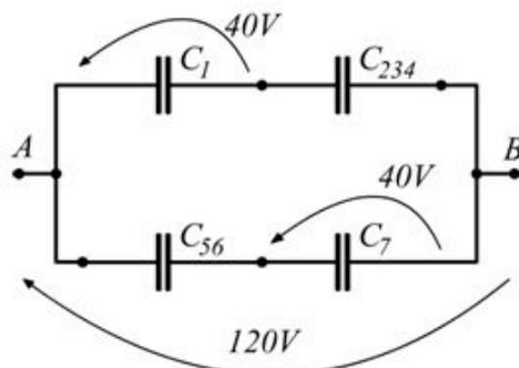
Come si nota dalla figura la tensione ai capi del condensatore equivalente  $C_{234}$  deve necessariamente essere di 80V quindi:  $V_2=V_3=V_4=80\text{V}$ .
