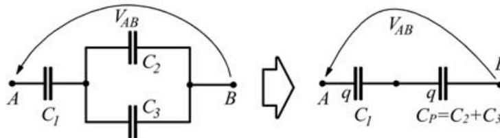
La serie  $C_1$ - $C_P$  produce la capacità equivalente  $C_T = \frac{C_1 C_P}{C_1 + C_P} = \frac{3 \cdot 6}{3 + 6} = \frac{18}{9} = 2 \mu\text{F}$
